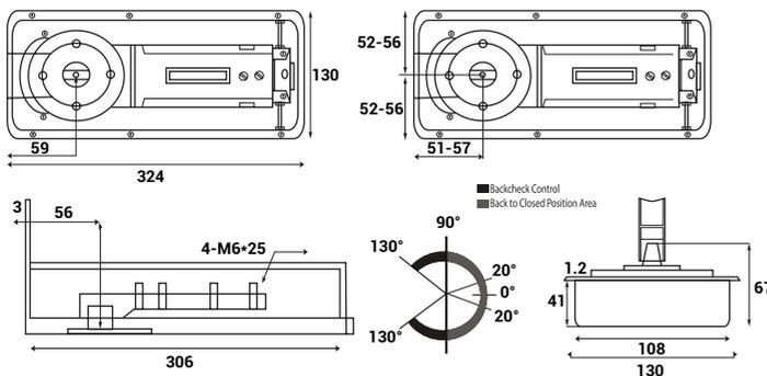
La bisagra de piso serie 350 es ideal para puertas de aluminio, madera, acero vaciado y cristal templado.
