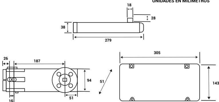
La bisagra de piso 90° marca DAWH, es ideal para puertas de aluminio, madera, acero vaciado y cristal templado.
