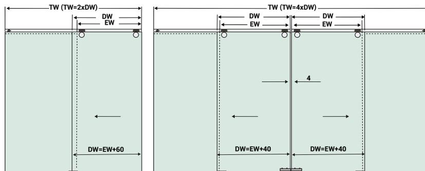
TW= Longitud del tubo      DW= Ancho de puerta      EW= Ancho de entrada
