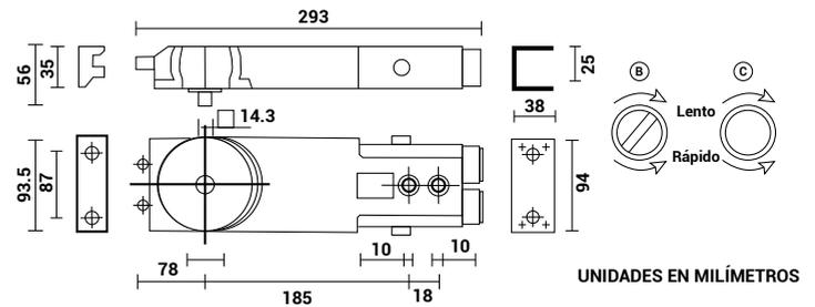
La bisagra aérea DAWH posee un diseño compacto para montar en la parte superior y de modo oculto en puertas de aluminio, madera y de acero vaciado. Disponible para puertas de acción sencillas o dobles y con válvulas para velocidad de cerramiento ajustables.
