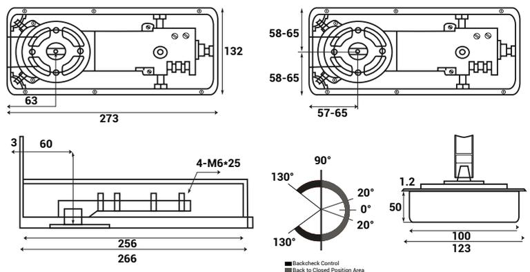
La bisagra de piso serie 150 es ideal para puertas de aluminio, madera, acero vaciado y cristal templado.
